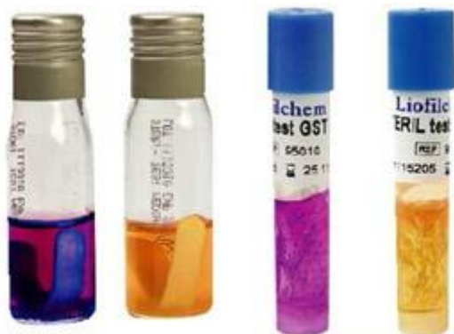
Рис. 6. Биоиндикаторы для контроля качества паровой стерилизации.
